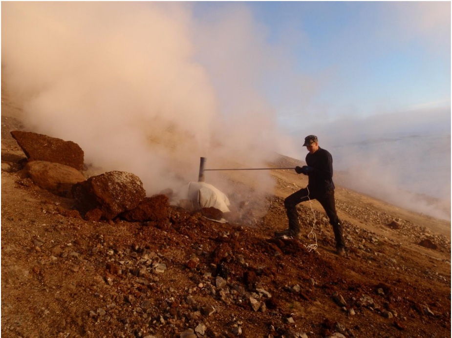
Bergur Einarsson aðstoðar Björn við mælingar á afli gufuholu í Kverkfjöllum. Tjaldað er yfir gufuopið og gufunni beint í gegnum stromp þar sem gufuflæðið er mælt.
